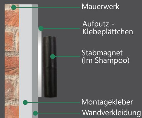
Bei der Aufputzvariante wird ein rostfreies magnetisches Edelstahlplättchen auf die Dekorplatte geklebt. Der wiederverwertbare Stabmagnet wird in die Flasche gegeben.
